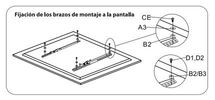
4. Deberá utilizar un espaciador si el panel posterior de la pantalla tiene forma irregular o punto d montaje embutido para compensar la diferencia de profundidad.
