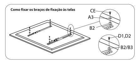
4. Se a sua tela plana tiver a parte posterior curva ou um ponto de montagem embutido, deve-se colocar espaçadores entre o braço de montagem e a tela plana para compensar a diferença em profundidade.
